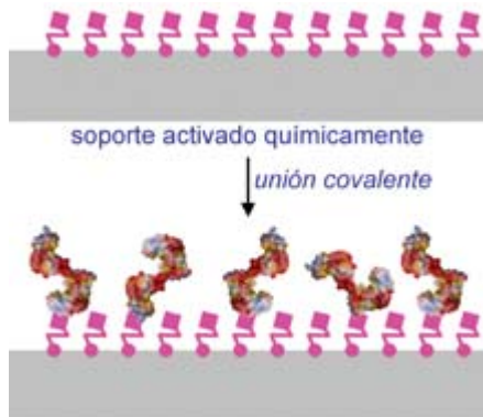
FIGURA 8. Inmovilización por anclaje químico. Aunque se ilustra con proteínas, es aplicable igualmente a ácidos nucleicos.
