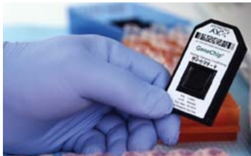
FIGURA 18. Un chip de DNA comercial , matriz de oligonucleótidos sintetizados in situ empleando fotolitografía sobre un soporte de vidrio modificado. Imagen en el dominio público, procedente de http://images.niams.nih.gov/detail.cfm?id=140
