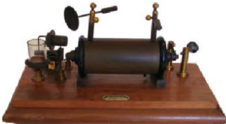
FIGURA 2. Carrete de Ruhmkorff fabricado por Arthur Preiffer [MFH LTI-038] (Capítulo 2, «Instrumentos de medida eléctrica y disposiciones accesorias»).
