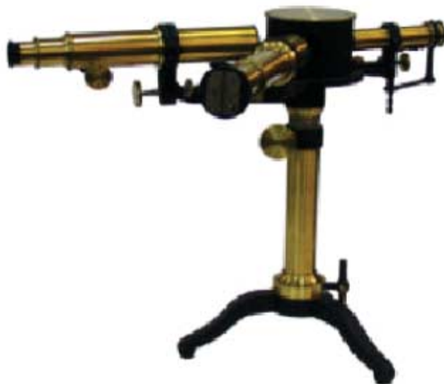
FIGURA 12. Espectroscopio de Bunsen y Kirchhoff construido por Jules Duboscq & PH Pellin [MFH 8545] (Capítulo 12, «Espectroscopias atómicas y moleculares de absorción y emisión»).
