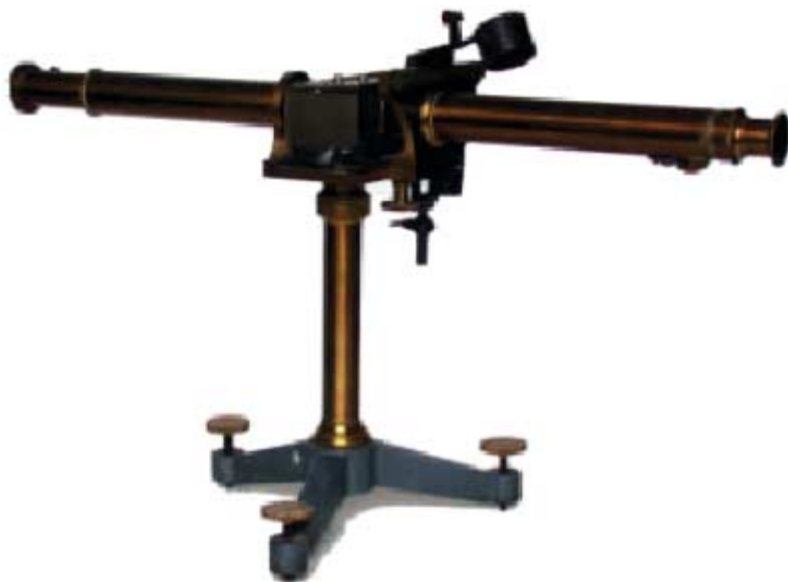
FIGURA 10. Refractómetro universal de M. R. Féry, fabricado por Ph Pellin [MFN 2987] (Capítulo 10, «Métodos refractométricos»).
