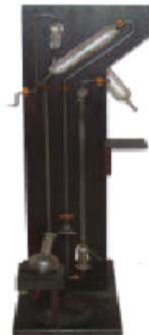
FIGURA 17. Vacuómetro de McLeod, según Ubbelohde [MFH 3880] (Capítulo 17, «Instrumentos para modificar y estabilizar la presión»).
