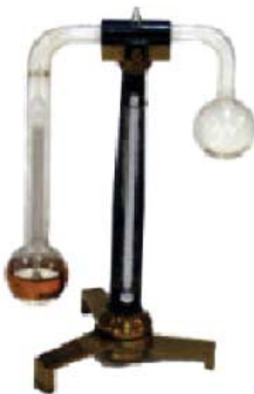
FIGURA 25. Higrómetro de Daniell [MFH 989] (Capítulo 25, «Medidas de presión, tensión de vapor y grado higrométrico»).
