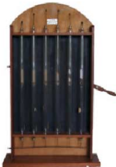
FIGURA 8. Escala de seis tubos para descarga de gases enrarecidos, fabricada por Eléctrica Sánchez [MFH LTI-037] (Capítulo 8, «Fuentes de energía radiante»).
