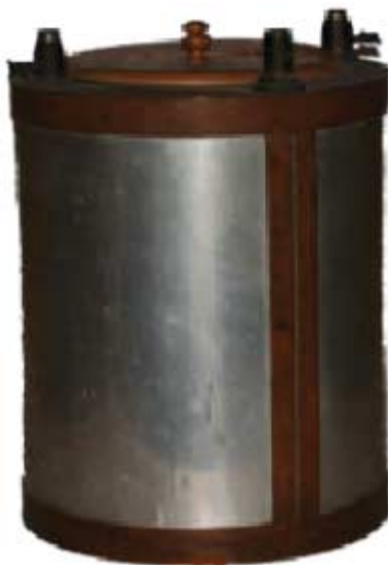
FIGURA 24. Calorímetro de Berthelot, fabricado por M. Álvarez [MFH 4163] (Capítulo 24, «Medidas de temperatura»).
