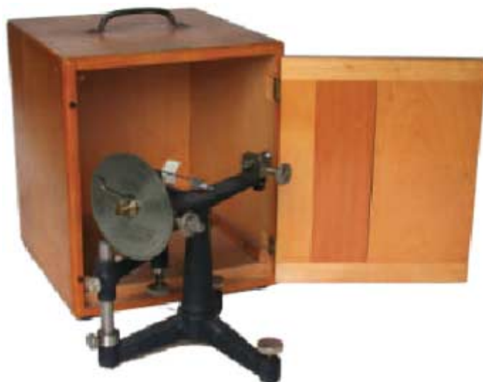
FIGURA 26. Tensiómetro de Nouy fabricado por Cemco Central Cientific Co [MFH 4069] (Capítulo 26, «Medidas de tensión superficial y viscosidades»).
