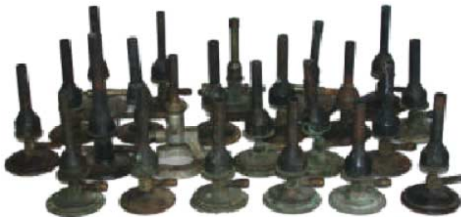
FIGURA 16. Veinticuatro mecheros de Bunsen [MFH 3818] (Capítulo 16, «Instrumentos de calentamiento y de termostatación; determinación de magnitudes térmicas»).
