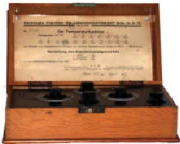
FIGURA 4. Potenciómetro Vereiniate Fabriken für Laboratoriumsbedarf Ges. M.b.H [MFH 8518] (Capítulo 4, «Potenciales electródicos y pilas electrolíticas, técnicas potenciométricas y de medida de pH»).
