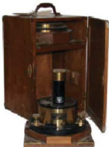
FIGURA 5. Galvanómetro de polarógrafo J. Nejedly [MFH 7592] en su caja (Capítulo 5, «Métodos eléctricos: polarografía y técnicas afines»).
