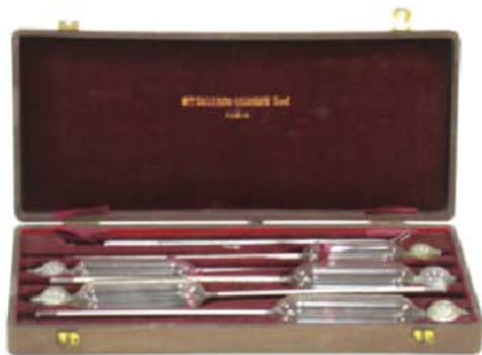
FIGURA 23. Cinco alcohómetros Gay-Lussac, fabricados por M. Salleron Du Jardín [MFH 3113] (Capítulo 23, «Determinación de densidades»).
