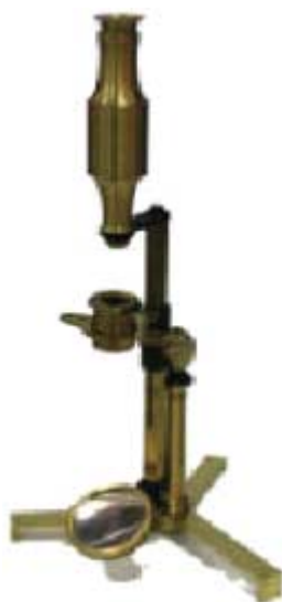
FIGURA 9. Microscopio compuesto Adams, fabricado por Adams, G. Son [MFH 1042] (Capítulo 9, «Óptica geométrica y microscopía óptica»).
