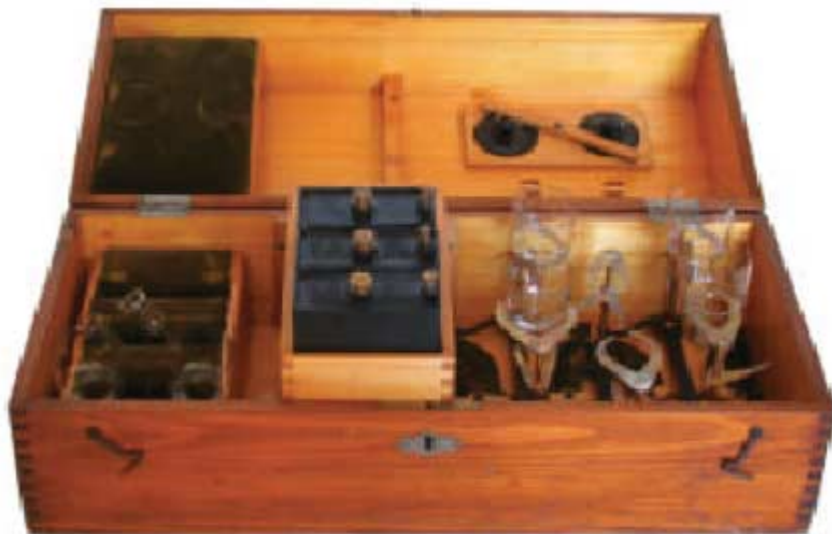
FIGURA 6. Caja de electrolisis Hartman & Braun para docencia [MFH LTI-057] (Capítulo 6, «Métodos conductimétricos, electrogravimétricos y culombimétricos»).
