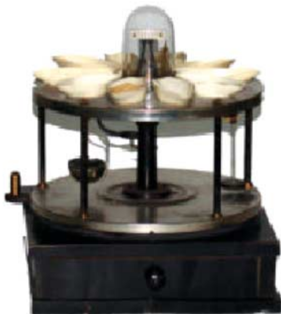
FIGURA 22. Balanza dosificadora de papelllos [MFH 1140] (Capítulo 22, «Medidas de masas»).
