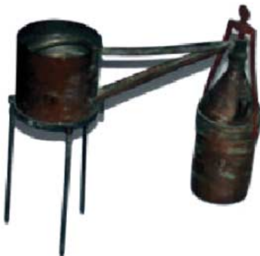
FIGURA 18. Alambique de Gay-Lussac par ensayos con vinos [MFH 2611] (Capítulo 18, «Operaciones de purificación de sustancias: separación de mezclas homogéneas»).
