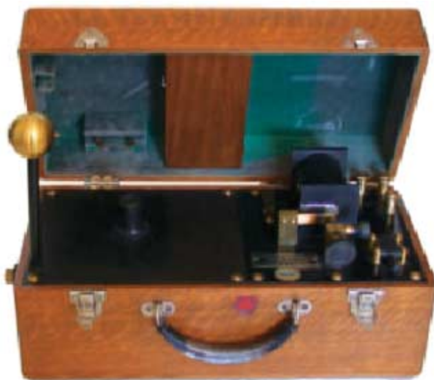
FIGURA 13. Aparato portátil de rayos X fabricado por Laboratorio eléctrico de rayos X Sánchez [MFH LTI-103] (Capítulo 13, «Técnicas de rayos X»).
