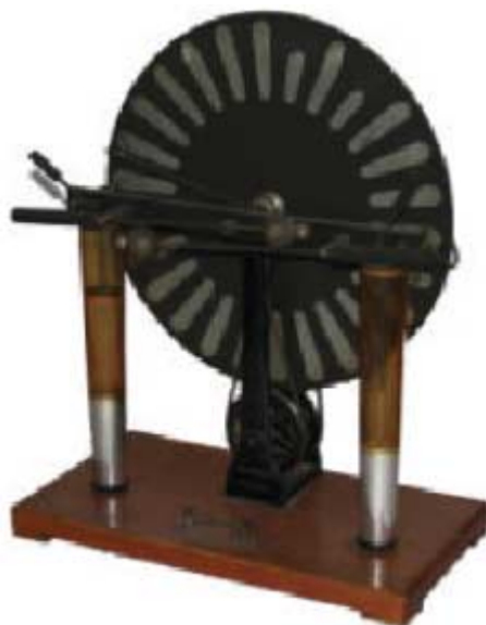
FIGURA 1. Máquina de Wimshurst, fabricada por Max Kohl AG Chemnitz [MFH 7588] (Capítulo 1 «Fuentes de energía eléctrica»).
